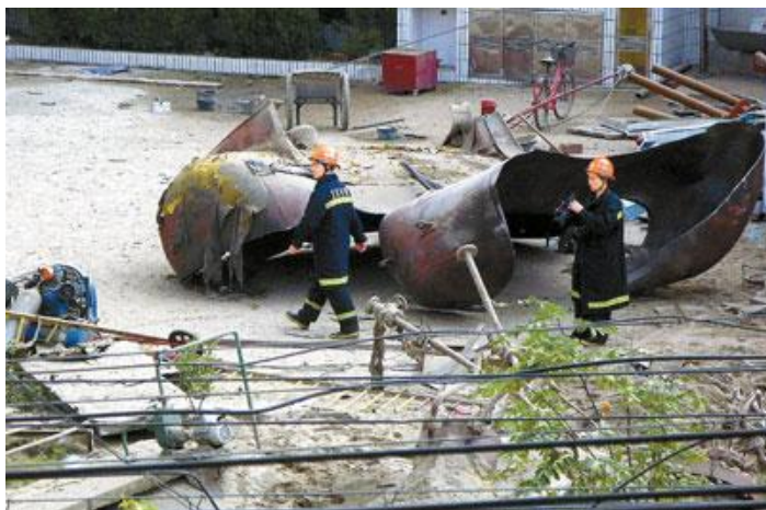
Рис. 2. Пример последствий взрыва РГС при проведении огневых ремонтных работ
